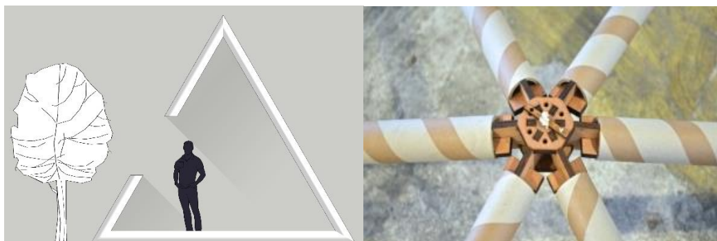
تصویر ۳- تصویر راست: فضای حاصل از ساختارهای مثلی و ایجاد کنج‌های بدون استفاده؛ تصویر چپ: نمونه‌ای از نحوه اتصالات کاغذی در گنبد‌های ژئودزیک (Burón & Sánchez, 2015, 26)
