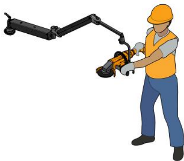
تصویر ۳- بازوی نگهدارنده ابزار (Zhu et al., 2021)
